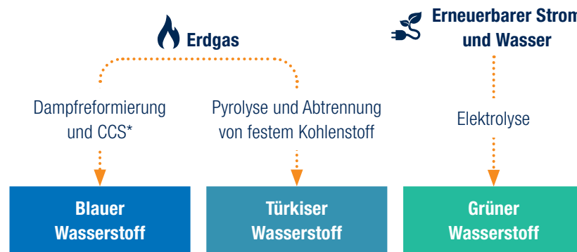
Abb. 1 Vereinfachte Darstellung der Erzeugungsverfahren von Wasserstoff
