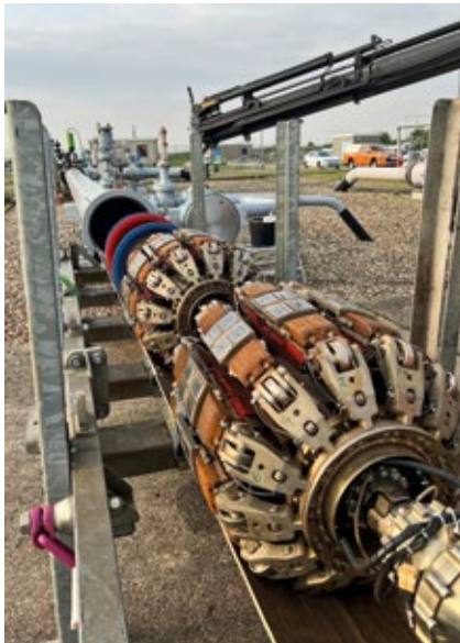
Bei der Zustandsanalyse der bestehenden Leitungen im Rahmen des Projektes wurde erstmals eine spezielle Messsonde zur Ermittlung von rissartigen Fehlern getestet.
