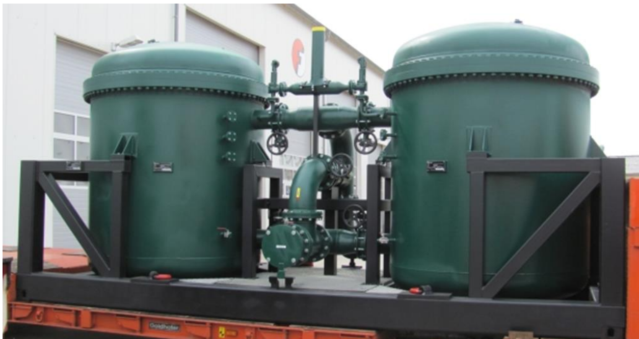
Abbildung 14: Beispiel Fa. Fangmann Industrie – Abscheiderskid mit 2 Adsorbieren (DN 250; DP64)
