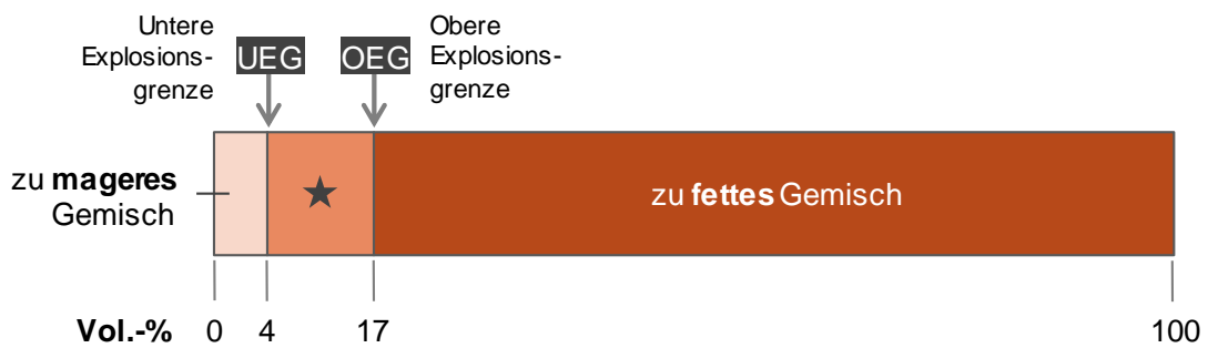
Abb. 3-6: Zündfähigkeit von Erdgas (eigene Darstellung nach [17])
