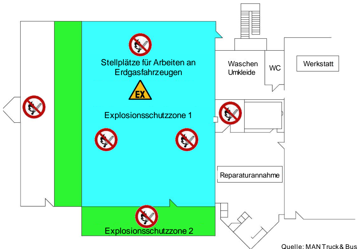
Abb. 5-5: Explosionsschutz zonen in einer Werkstatt für Gasfahrzeuge [26]
